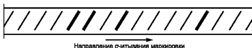
Рисунок 2 — Пример прокатной маркировки предприятия-изготовителя под номером 14
